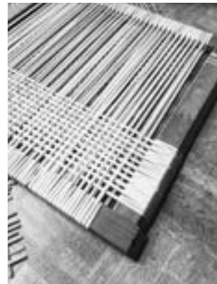
③ | 木枠に巻きつけ背と座の接点に巻き終わりがくるように調整しながら釘で留める
