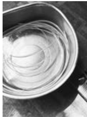
② | しなやかに曲がるように水に皮籐を浸して1本ずつ張る
