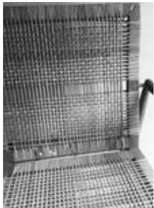
① | 籐の経年劣化によって破断が生じている
