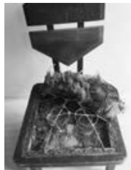
① | バネの力に押されるように、表面のシートが切れ、バネを抑えていた紐も切れたため、座が異常に盛り上がっていた
