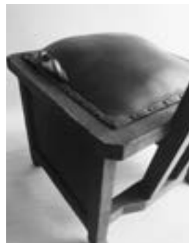
① | バネの力に押されるように、表面のシートが切れ、バネを抑えていた紐も切れたため、座が異常に盛り上がっていた
