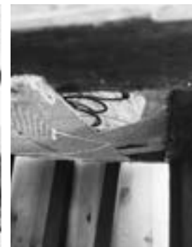
② | 底に打ち付けてある板を取り除き、ウェビングテープとバネを敷きなおした
