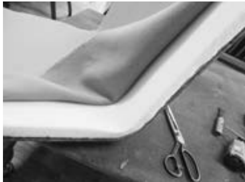
② | 木枠にクッション材を張り、背表、背裏の2枚の生地を張って溝に沿ってタッカーで留めていく
