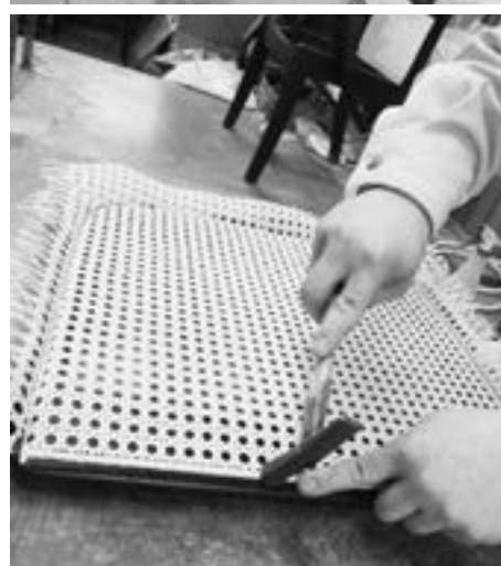
くさびを使って溝にシートを押し入れて、ボンドと5ミリ径の丸芯で留める
