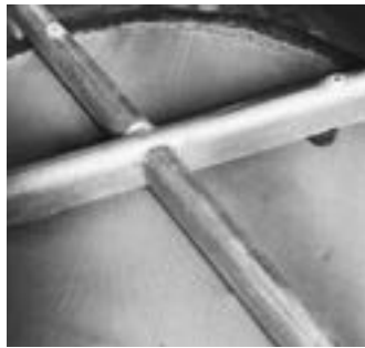
① | リベットで座と脚部をかしめ留めている
