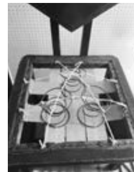
② | 底に打ち付けてある板を取り除き、ウェビングテープとバネを敷きなおした
