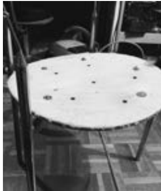
② | かしめ留め部分を切り取って座に鬼目ナットを仕込み、ボルトで脱着可能な仕様に変えた
