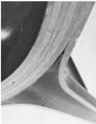
隙間とひびにパテ埋めを施した
